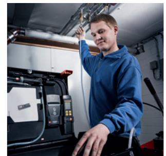
Trink- und Abwasserleitungsprüfung mit Hochdrucksonde bis 25 bar
