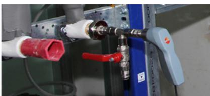
Belastungsprüfung mit Wasser oder Druck > 1 bar mit Hochdrucksonde und -anschluss
